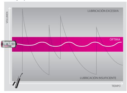
La descarga continua de lubricante con simalube evita eficazmente la lubricación insuficiente o excesiva que a menudo aparece con la lubricación manual.
